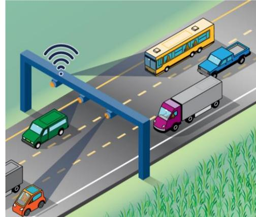
**电子收费如何运作。**全电子系统将自动向在高速公路上行驶的车辆收取通行费。转发器（贴在挡风玻璃上的小标签）被读取并连接到预付费帐户。如果车辆没有转发器，摄像头会拍摄汽车的车牌，并向注册车主收费。这样可以保持交通畅通，而不会停下来支付通行费。
